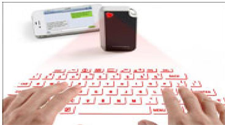
یک تولید کننده تجهیزات الکترونیکی با عنوان بروک استون اقدام به تولید یک صفحه کلید مجازی جدید کرده که با استفاده از تجهیزاتی که داخل یک جاکلیدی کوچک قرار داده یک صفحه کلید لیزری روی یک سطح صاف ایجاد می کند.
